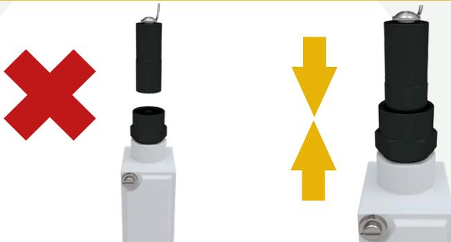
CON ESTE RECURSO, LA CARGA SOLO SE HACE PERMISIVA CUANDO EL OPERADOR CONECTA LA LLAVE DE VALIDACIÓN (ANEXA AL BRAZO) EN EL SENSOR DE DESBORDE (MÓVIL)
